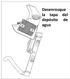
Figura 33 Adición de refrigerante
