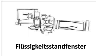
Abbildung 26 Kontrolle des vorderen Bremsflüssigkeitsstands
