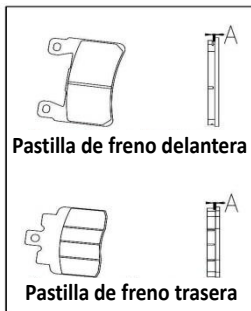
Figura 30 Inspección del revestimiento de fricción
