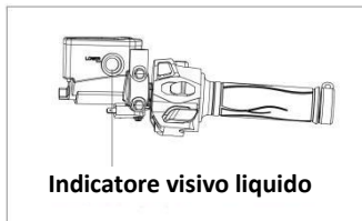
Figura 26 Controllo livello liquido freno anteriore
