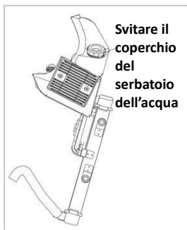
Figura 34 Aggiunta di liquido di raffreddamento
