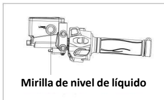
Figura 26 Comprobación del nivel del líquido de frenos delantero
