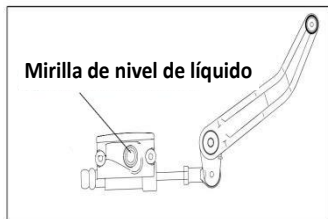
Figura 31 Comprobación del nivel del líquido de frenos trasero
