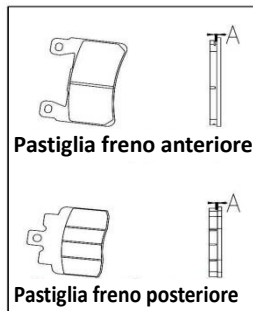
Figura 30 Controllo della guarnizione d' attrito freno posteriore
