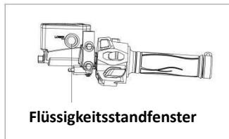
Abbildung 26 Kontrolle des vorderen Bremsflüssigkeitsstands
